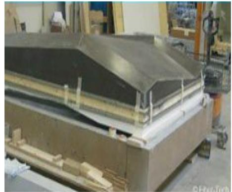
의 Biotex™와 bio-polyester laminated 바이오 복합재료임. 두께는 10mm, 6mm이며 open-mould 공정으로 바이오 복합재료 laminate를 생산하였음. 제품의 설계, 제작, 사용 기간 뿐 아니라 새로운 제품으로의 재활용까지 포함하는 제품의 수명주기를 고려하여 제작함.
