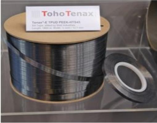
그림. PEEK/CF prepreg tape(w:12.7mm)-HTS45 grade 활용
