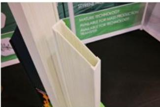
그림. PA6/glass fiber beam(Pultrusion)
