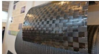
그림. PA6/CF prepreg fabric
