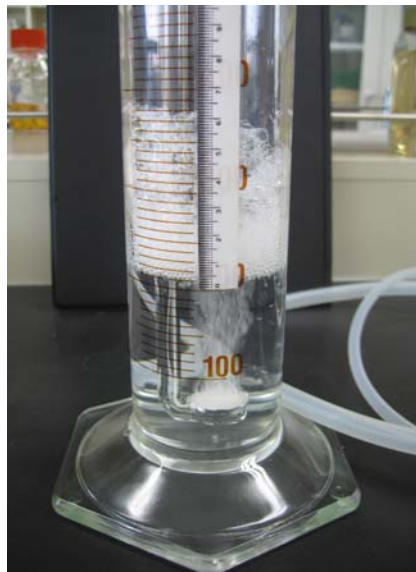
그림 8-4. 기포성 측정의 모습
