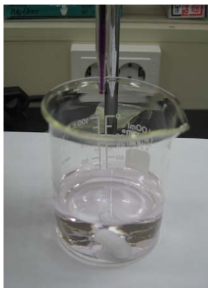
그림 9-3. 과망간산칼륨을 이용한 적정법의 모습
