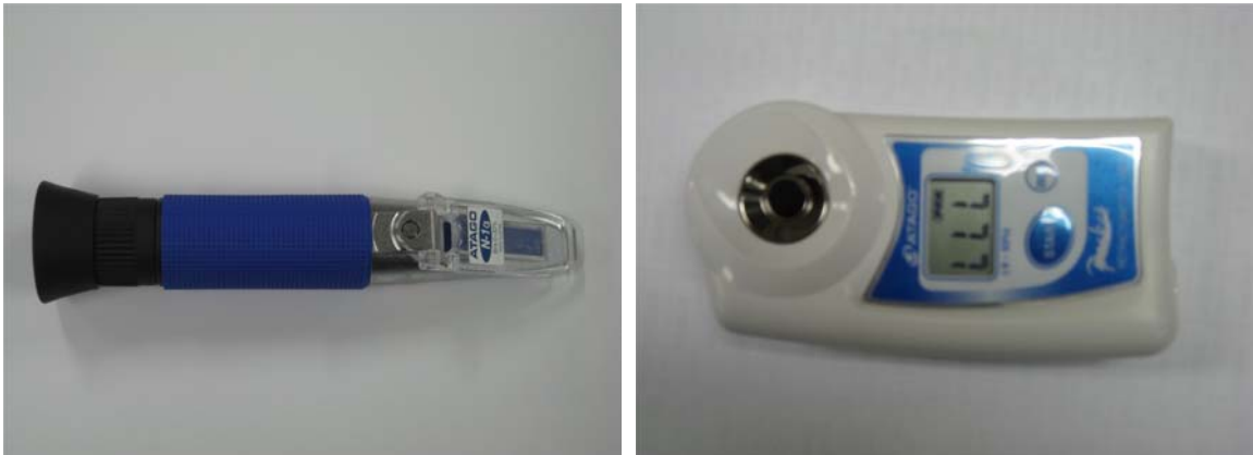
그림 8-2. 수동식 굴절계(좌)와 디지털식 굴절계(우) 모습
