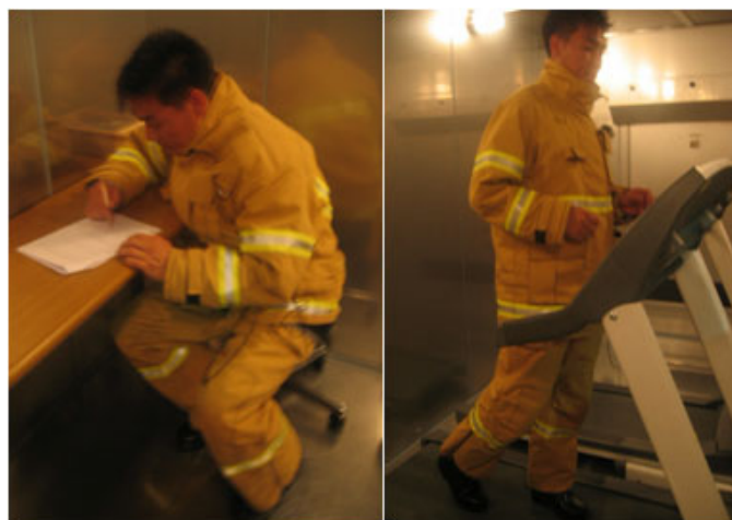
[그림 6] Nitinol 스프링을 부착한 지능형 소방복의 착용성능 테스트 (기존의 소방복에 비해 고온에 노출시 단열성은 크면서 가볍고, 쾌적하여 열적 스트레스를 최소화할 수 있음)
