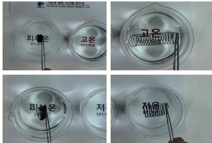
[그림 5] 형상기억 합금으로 만든 스프링의 온도에 따른 길이 변화 (스프링의 회전수에 따라 공기층의 두께가 달라지며, 저온 또는 고온용으로 제작이 가능함)
